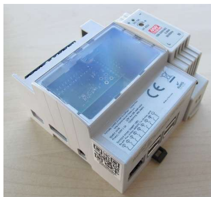
Fig. 1 : Terminal de chambre SE10 sur rail DIN (SE10H, à gauche) ou dans un compartiment plat (SE10F, au milieu). Connecteur en option pour capteurs externes (à droite)
