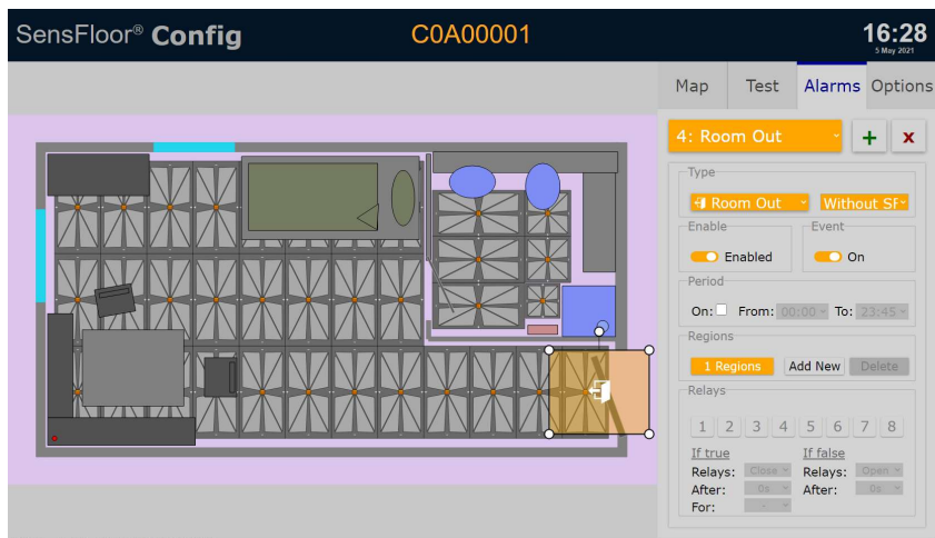
Fig. 33: Configuration de l'événement Room Out sans SensFloor dans le couloir
